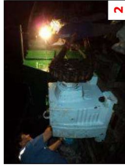
รูปที่ 2 ถอด Bolt ที่ยึด Gear box ออก เพื่อเคลื่อนย้ายชุดขับเคลื่อนให้สะดวก
