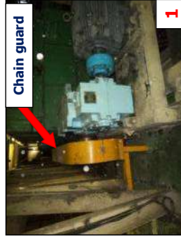
รูปที่ 1 ถอด Chain guard โดยการคลาย Nut ที่ยึดไว้ออกทั้งหมด
