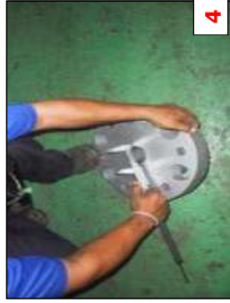
รูปที่ 4,5 ตรวจสอบความสึกหรองของ Sprocket + Coupling
